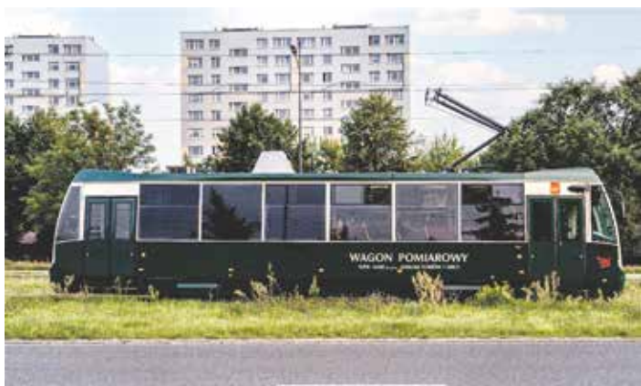
Rys. 2. Zmodernizowany tramwaj typu 8052 2D-T nr 92338, jako wagon pomiarowy (foto Krystian Czarnecki)
