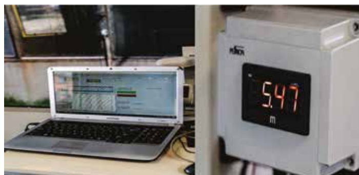
Rys. 5. Stanowisko do pomiaru wysokości zawieszenia przewodu jezdnego (foto Krystian Czarnecki)
