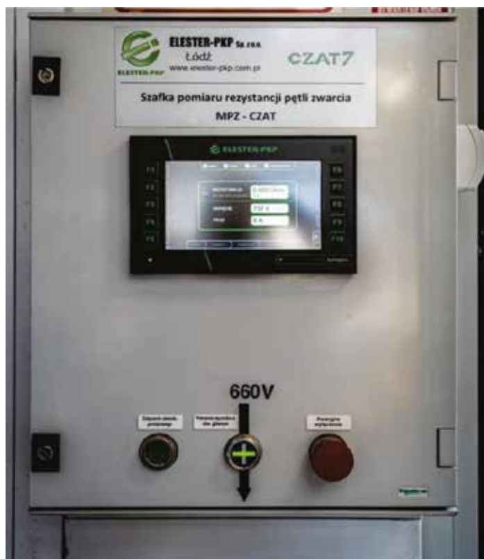
Rys. 3. Układ do pomiaru rezystancji pętli zwarcia MPZ-CZAT (foto Krystian Czarnecki)
