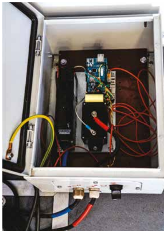
Rys. 4. Rejestrator napięcia trakcyjnego 600 V DC (foto Krystian Czarnecki)
