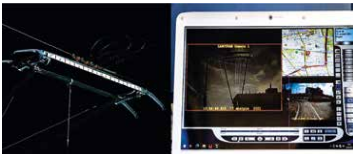
Rys. 6. Stanowisko rejestracji współpracy pantografu z siecią jezdnią (foto Krystian Czarnecki)
